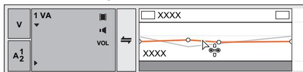
De plus, en faisant glisser en maintenant enfoncée la touche [Alt] du clavier, vous pouvez ajouter automatiquement un nouveau point entre les deux autres points et le déplacer en parallèle. Vous pouvez régler le nombre d'images dans les 2 points à n'importe quelle extrémité où un point automatiquement ajouté est placé à l'aide de [Source] dans [Paramètres utilisateur] → [Durée].
