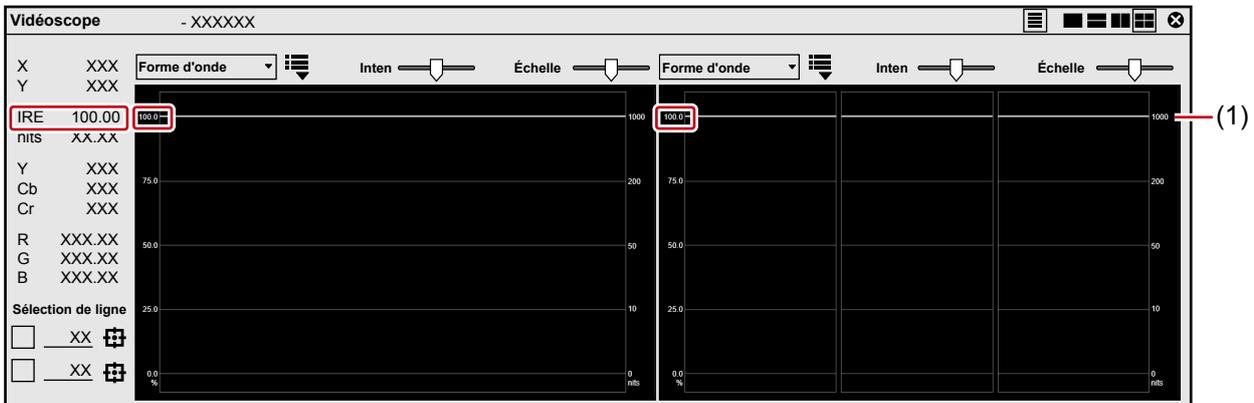
Dans le cas des clips de couleur mat noirs créés dans la gamme de couleur sûre, IRE0 apparaît. (à la position (2)) L'ajustement n'est pas nécessaire lorsque IRE est une valeur négative.
